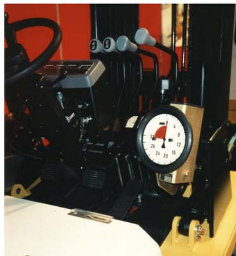
Dieser Gewichtsanzeiger wird an das Hydrauliksystem Ihres Gabelstaplers angeschlossen. Der Wägevorgang wird durch Druck auf ein Spezialventil ( Hand- oder Fußbedienung ) ausgelöst. Die Waage ist nur so lange in Funktion wie das Ventil durch Druck geöffnet ist. Die Nulltarierung / Taragewicht - Unterdrückung, ist schnell und unkompliziert mit dem drehbaren Ziffernblatt möglich.
