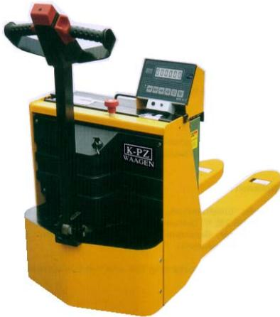
Diese Waage kann in elektrisch getriebene Hub - Stapler eingebaut werden. Der Einbau erfolgt ausschließlich in unserem Werk, in ein vom Kunden angeliefertes Grundgerät. Die Gabelmaße werden annähernd beibehalten, so daß bei der Handhabung sowie bei den Kapazitäten keine Einschränkungen gegeben sind. Der Einbau ist in fast allen handelsüblichen Fabrikaten möglich. Für den Umbau muß das Gerät mit einer Batterie ausgestattet sein!
